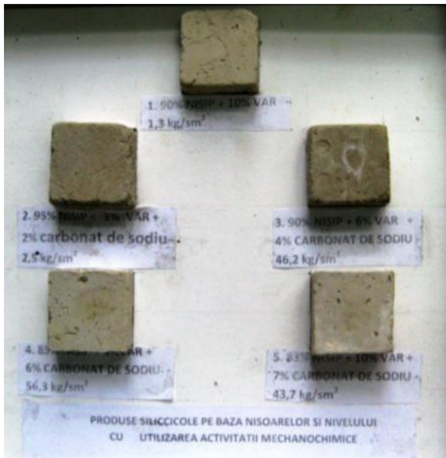
Fig. 1 Materiale silicalcice preparate din amestec de nisip măcinat și calcar activat prin metode mecano-chimice
