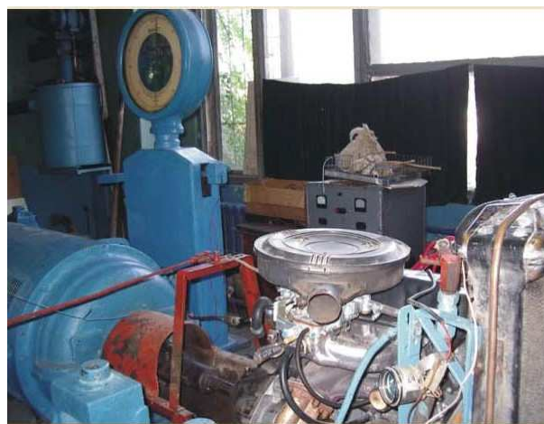
Stand pentru încercarea motoarelor cu ardere internă
