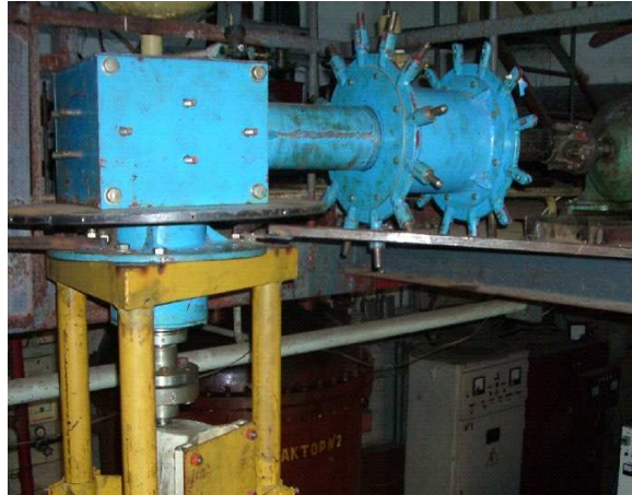
Mostră de laborator a generatorului asincron cu trei faze cu puterea de 0,3kW și n=500 rot/min
